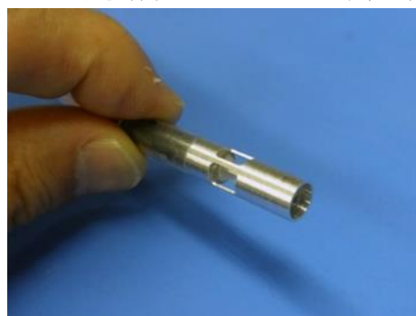
図 1 磁性流体軸シールを用いたカテーテル設置式超小型軸流血液ポンプ ver.2
