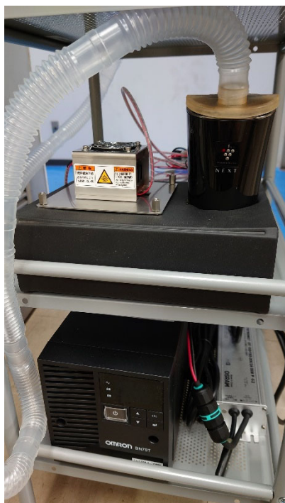
図3 ウイルス不活化装置 紫外線発生器 (左上) プラズマクラスター (右上) 無停電電源装置 (下)
