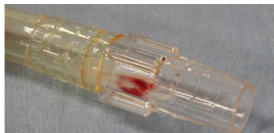
図1 上：左心補助の概念図とコネクタの位置 下：コネクタに生じた血栓の例
