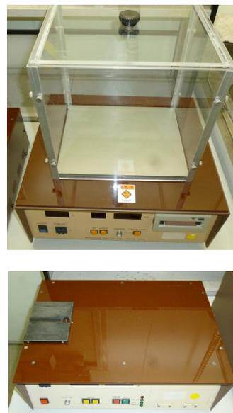
図1 マウスにおける疼痛（侵害受容反応）の解析用の専用機器（上：hot-plate テスト、下：tail-flick テスト）
