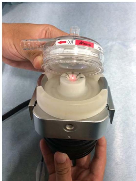
図 1：血液凝固光センサ
