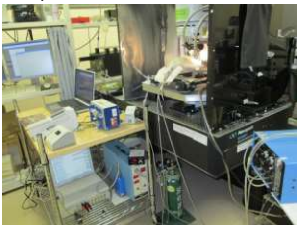
図1：加齢医学研究所共通機器の2光子顕微鏡実験室において構築した炭酸ガス負荷を行える実験系。
