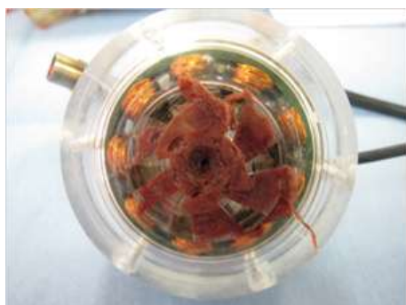
(a) インペラ底面（中央貫通部）およびインペラ流路に生じた血栓
